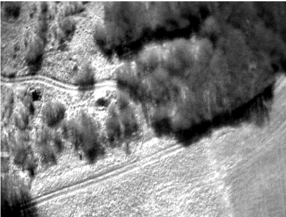
Figur 26. Thermalt billede. Det ses at billedet bliver uskarpt når der flyves over træer (øverste højre hjørne).
